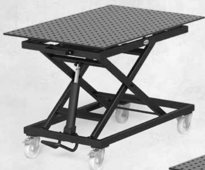
Pokretni sto za podizanje: Dimenzije (D k Š): približno 1.115 x 630 mm, Težina (bez ploče): cca. 65 kg
