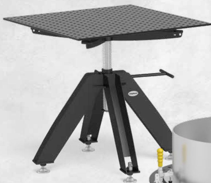
Rotirajući sto sa podesivom visinom „Stacionarni“: Dimenzije (D k Š): cca. 785 k 785 mm, Težina (bez ploče): cca. 70 kg
